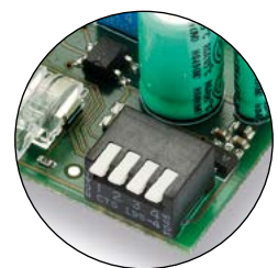
DIP SELEZIONE LIVELLO DI SENSIBILITÀ
