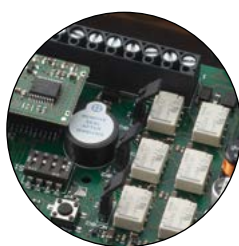
UNITÀ FISSA, GESTIONE USCITE DI SICUREZZA (NC/8,2kΩ)
