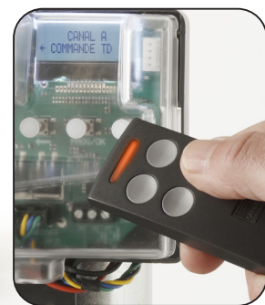
PROGRAMMAZIONE AVANZATA TRAMITE DISPLAY LCD (16 CIFRE X 2 RIGHE) IN SEI LINGUE DIVERSE
