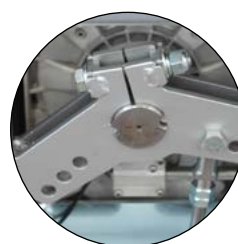
BILANCIAMENTO RINFORZATO E MOTORIDUTTORE PERSONALIZZATO PER ASTA 3,4,5 METRI ELDOMSDG
