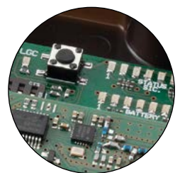
8 LED ROSSI STATO SICUREZZA 8 LED VERDI LIVELLO CARICA- BATTERIA
