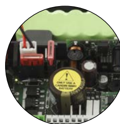
BATTERIE DI EMERGENZA NELLE VERSIONI CC242ETOPCB e CC242EXTOPCB
