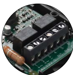
CONTATTO DI SCAMBIO NC-NA-C
