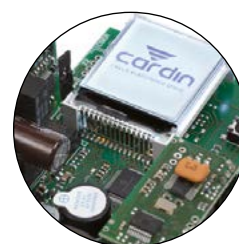
AUTOPROGRAMMABILE TRAMITE DISPLAY LCD GRAFICO
