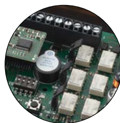
UNITÀ FISSA, GESTIONE USCITE DI SICUREZZA (NC/8,2kΩ)
