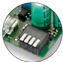
DIP SELEZIONE LIVELLO DI SENSIBILITÀ
