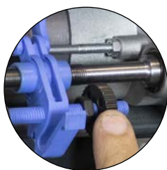
FINECORSA DI APERTURA E CHIUSURA INTEGRATI
